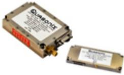
**Trasmettitori Digitali** multi-mode **TIMTER™**; in piccoli e robusti package, offrono prestazioni e valore senza pari. Modulazione PCM/FM, SOQPSK-TG (STC e LDPC), ARTM CPM; banda L/S/C, alta efficienza spettrale per un miglior impiego della potenza e della banda RF, basso consumo, potenza programmabile, elevata immunità a shock e vibrazioni, ...
