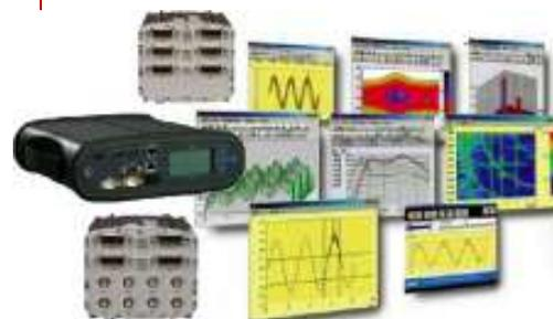
**Condizionatori** interni per termosonde, sensori estensimetrici e potenziometrici, accelerometri, microfoni; segnali in tensione, corrente e tachimetrici; I/O digitali; uscite analogiche (DAC); interfacce per CANbus.
